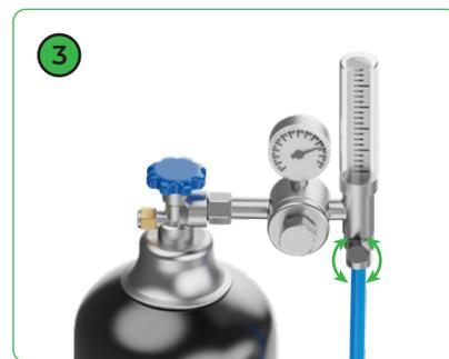
(3) Réglez le débit de gaz à 15 L/min - 30 L/min
