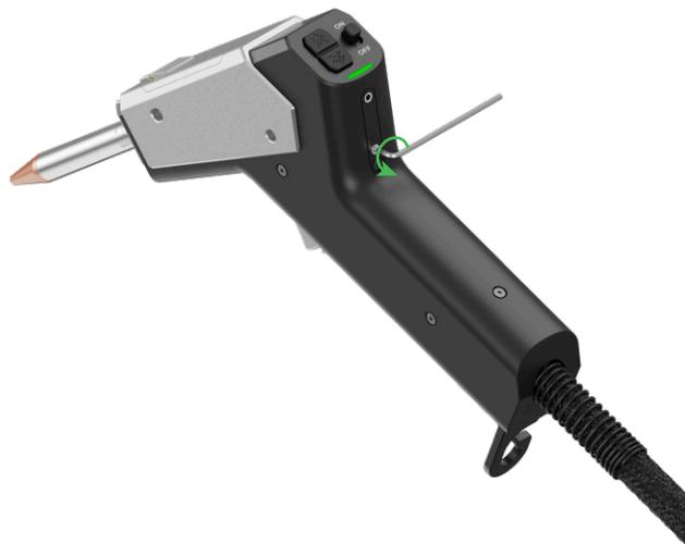
(4) Tournez alternativement les vis des trous 1 et 2 dans le sens des aiguilles d'une montre pour les serrer lentement, tout en gardant le spot rouge visible et clair.
